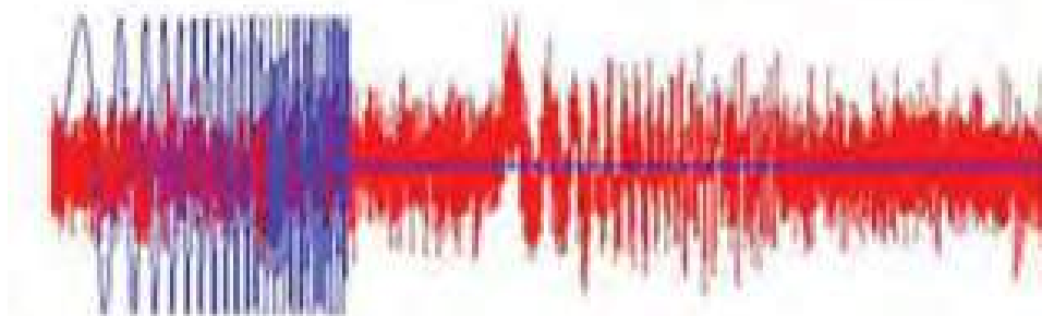
Импульсный сигнал с ЛЧМ с переменной частотой и неизменной амплитудой
