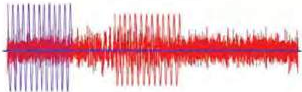
Сигнал незатухающей волны (пакет импульсов)
