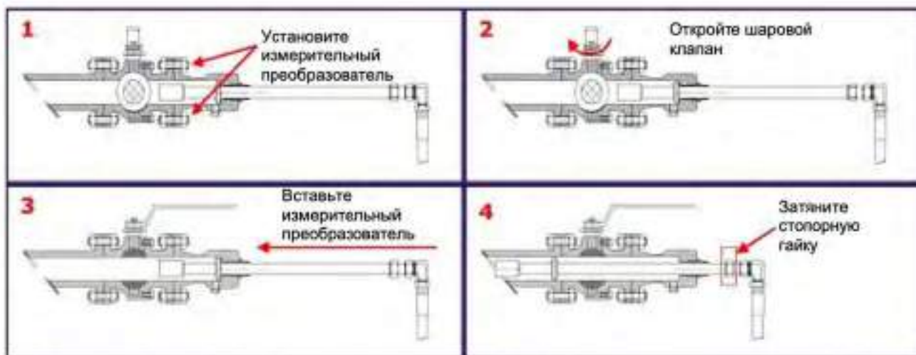
Рисунок 38 – Установка полноразмерного измерительного преобразователя
