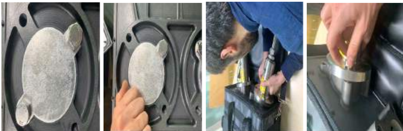
Демонстрация установки датчиков на FlareCal
